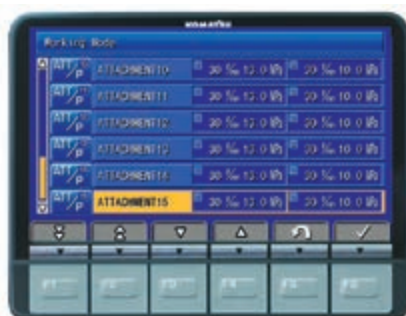
Integrované ovládanie pracovného zariadenia Komatsu (KIAC)
