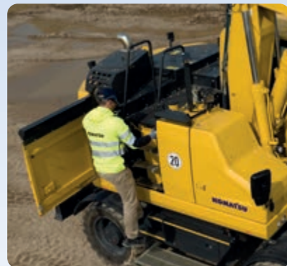
Zábradlia a protišmykové dosky pre pohodlný a bezpečný prístup pri údržbe
