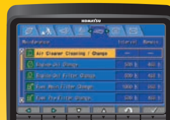
Obrazovka údržby na monitorovacom systéme zobrazuje časy výmeny oleja a filtrov
